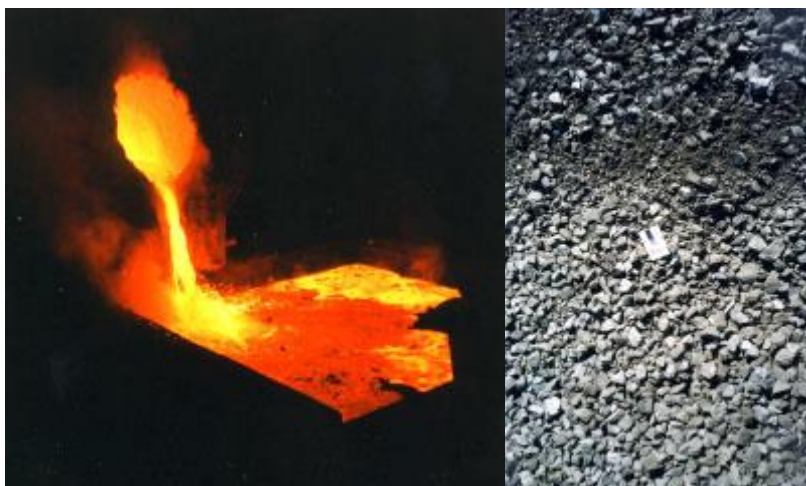
【溶融炉からの出 しゅっさい 滓状況】
