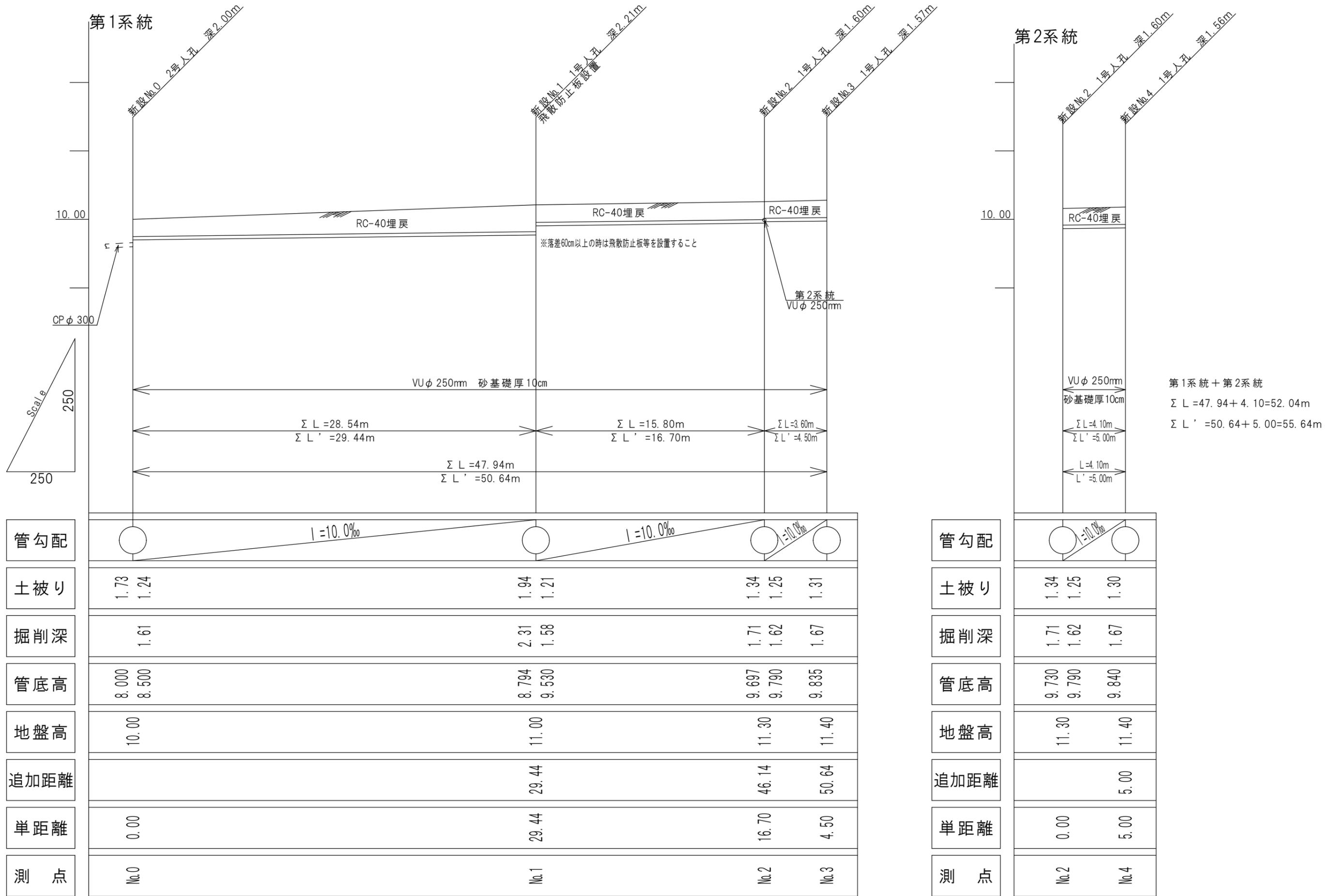
参考図-3 排水計画縦断面図の作図例
