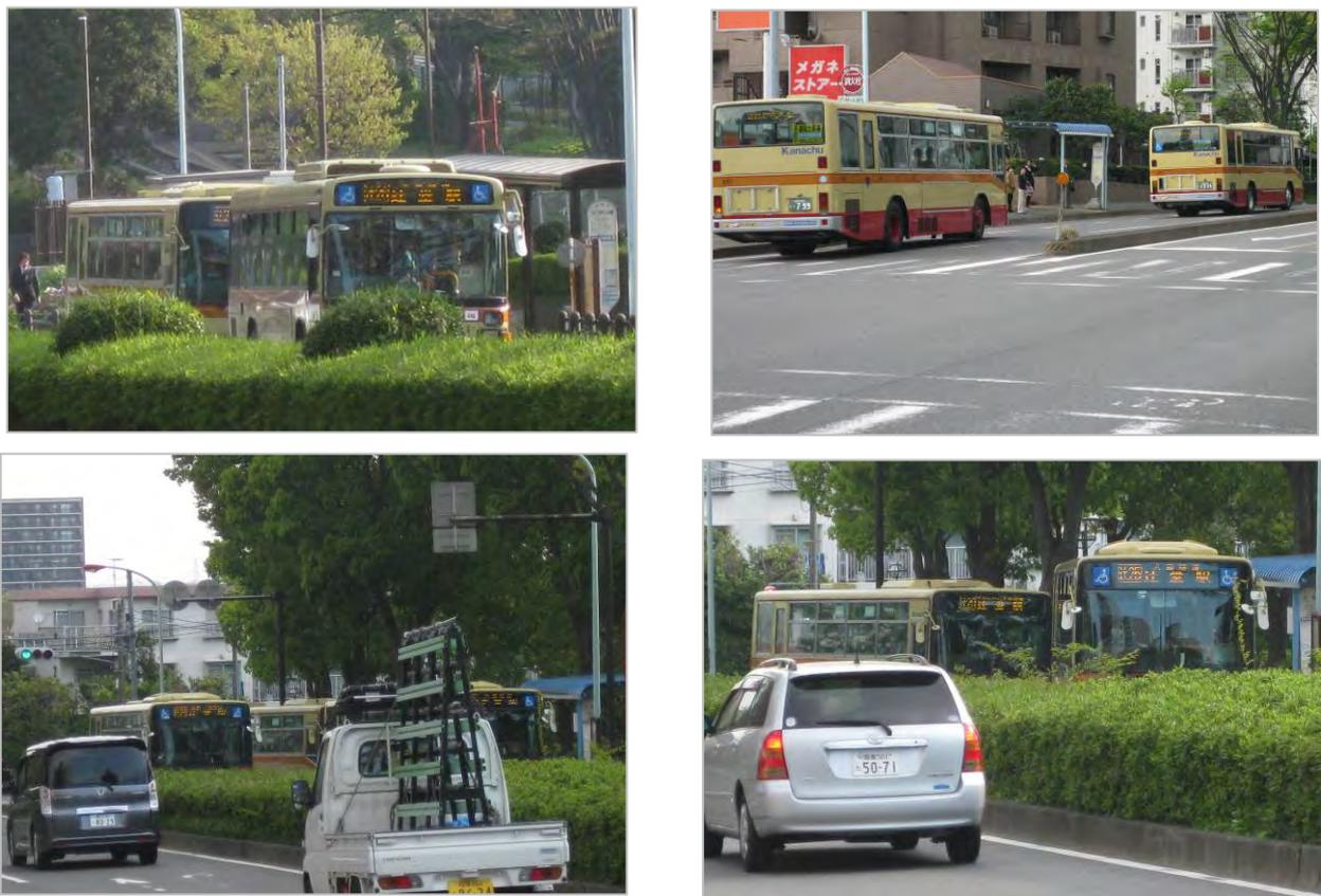
図-10 非効率な運転の状況（遅れた前のバスに、後方のバスが接近する状況）
