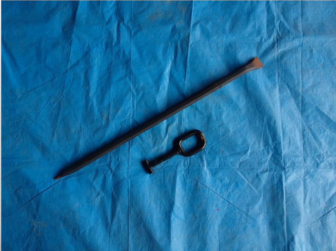
貯水槽蓋開閉金具 (コンクリート製のフタ開放用)
