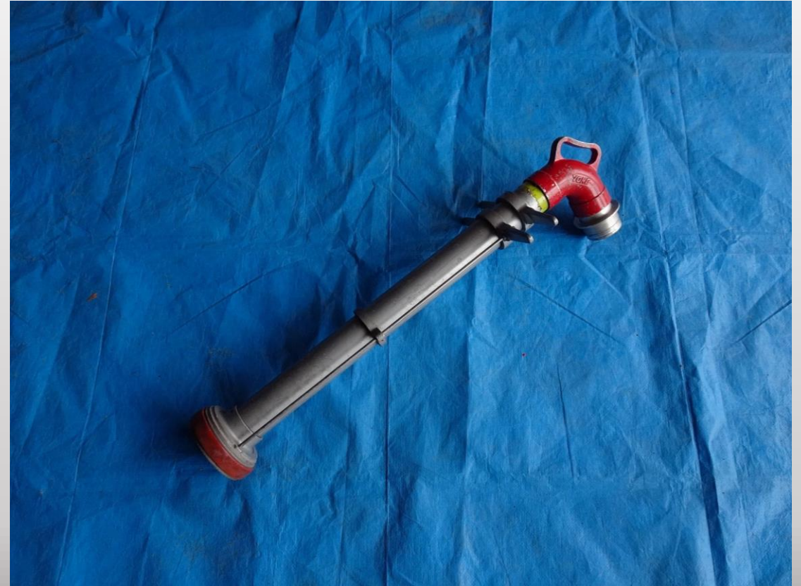
スタンドパイプ
